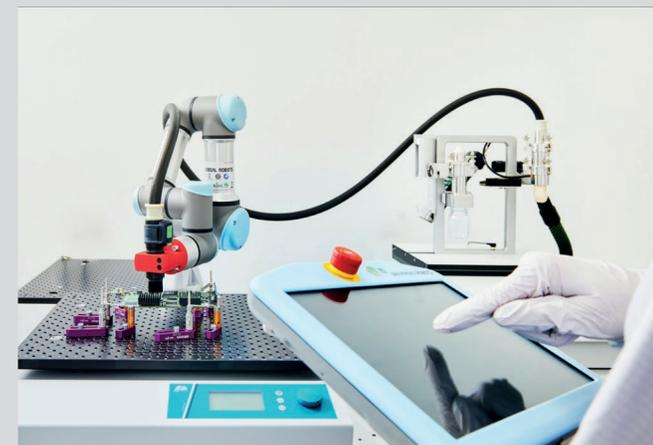
Diese Extraktionsmethode ist ideal für die Sauberkeitsprüfung großflächiger Bauteile mit trocken anhaftenden Partikeln und für Bauteile wie Elektronikbauteile, Kabelbäume oder Styrodur-Behälter, die nicht nass-extrahierbar sind.
