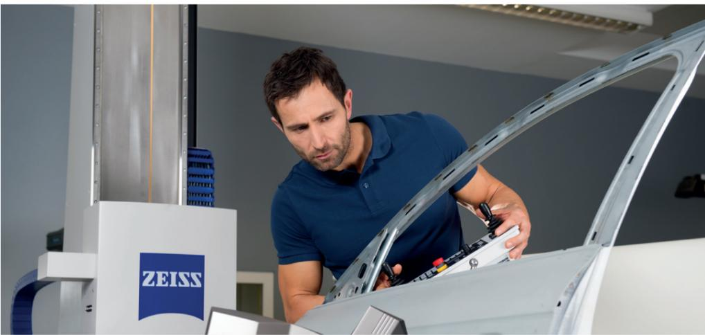
Die Horizontalarm-Messmaschine PRO T von ZEISS ist ein Neuzugang in unserem Maschinenpark, über den wir uns besonders freuen. Mit ihr können wir zum Beispiel Karosserieteile verlässlich genau und effizient messen. Sie begeistert uns durch ihre sehr hohe Geschwindigkeit bei gleichzeitig hoher Messgenauigkeit im Car Body-Bereich.
